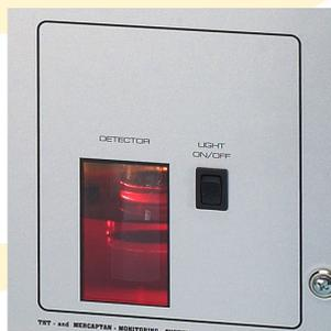
detettore elettrochimico con sensore livello ed integrazione automatica dell'acqua distillata
