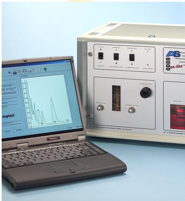
Il gas cromatografo ODOR on-line è un sistema completamente automatico per la quantificazione degli odorizzanti e delle impurità naturali a base di solforati presenti in tutti i tipi di gas (gas naturale, gas città, gas liquido, GPL, ossigeno).
